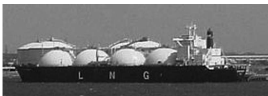
LNG（液化天然ガス）専用運搬船（ネットより）
