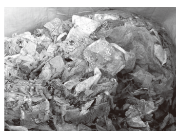
写真1 生ごみ破碎分別後残渣 (生ごみ付着プラ袋・容器) 重量比100% 含水率60~70%
