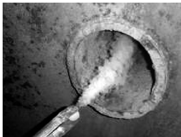
写真2 豎型・横引き型ガス抜き管事例と横引きガス抜き管への空気の流入状況例
