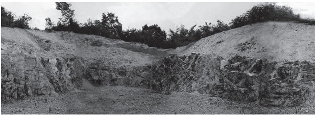
写真7 吉備高原の強風化岩と弱風化岩境界（岡山県久米南町）
