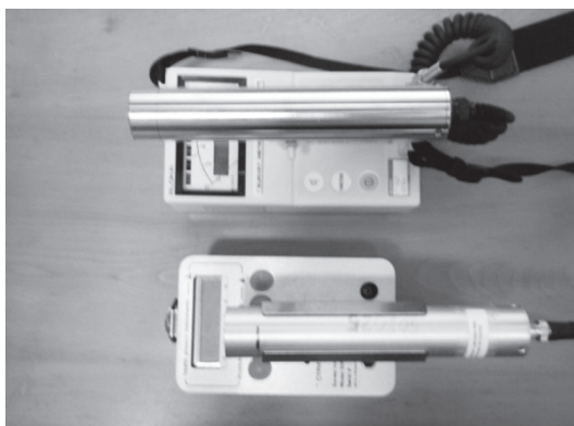
上段；アロカTCS-171B（エネルギー補償機能付き） 下段；HPI-5000型（エネルギー補償機能なし）
