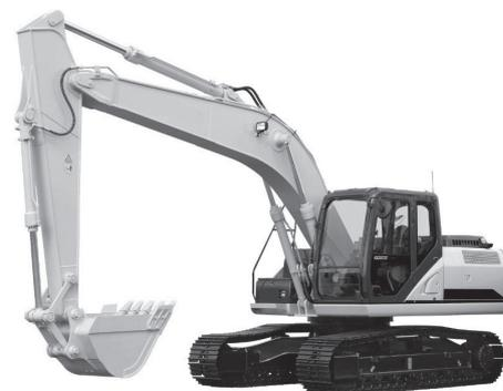
写真3 バックホウ（油圧ショベル）
