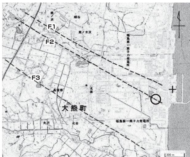
図2 原子力発電所付近に推定される断層（国土地理院地図使用）○：湧水法面 F2断層は原子炉建屋に達している
