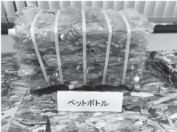
写真2 廃PETボトルの圧縮梱包事例
