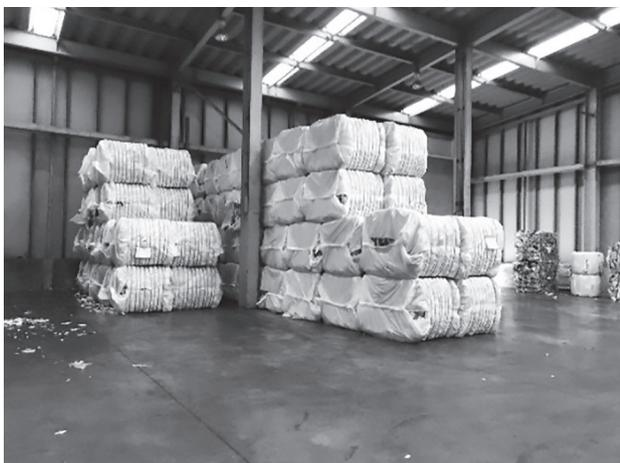
写真3 容器包装廃プラの圧縮梱包事例
