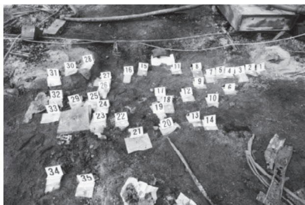
写真5 写真4の第1区画の拡大写真（延長コードの配置に類似した溶融痕分布）
