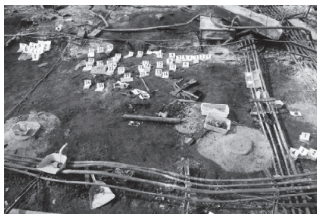
写真4 正殿第1区画を東側から撮影（奥の西側壁に沿って分布する溶融痕）
