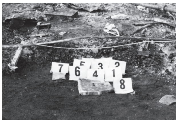
写真6 写真4の第5区画の拡大写真（手前のLED照明灯付近の溶融痕分布）
