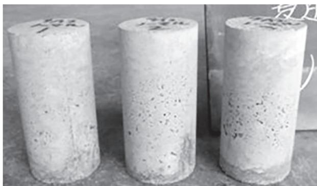
写真7 セメント硬化体の浸食前の様子<sup>5)</sup>
