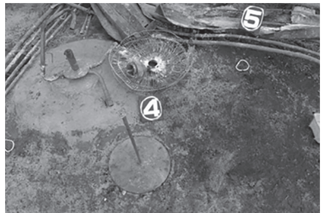
写真12 分電盤跡の前に送風機が見分できる 4)
