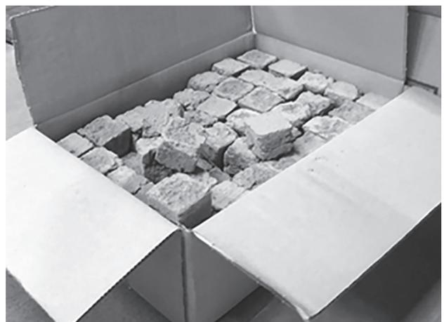
写真21 栄養分・フルボ酸鉄の固化剤
